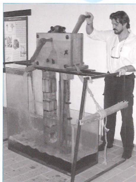
La ricostruzione in scala al vero di una pompa di sentina romana del tipo a bindolo in funzione nella Sala IV
